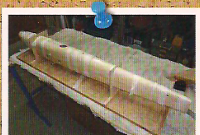
30 - Cette fois, les demi-coques sont collées ensemble, dans un bâti qui assure de la symétrie du fuselage. Du «masking-tape» est utilisé pour tenir les deux parties serrées durant le séchage.
