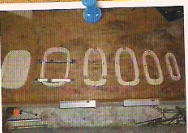
27 - Maintenant, il reste à préparer les couples qui reprendront les efforts issus de la voilure, des empennages, du moteur, éventuellement du train, etc.
