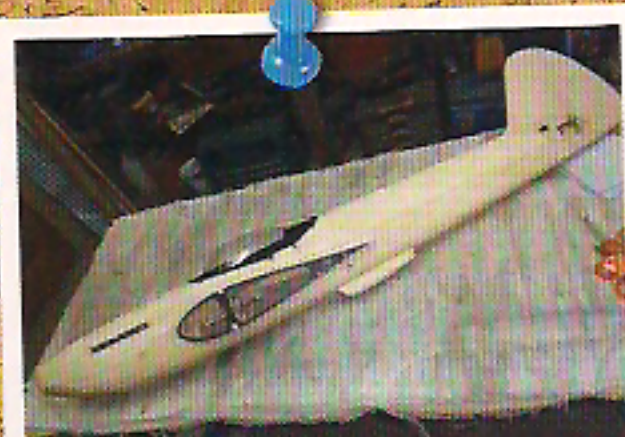
32 - Voilà : notre fuselage a reçu divers équipements et il a fière allure. Il n'a rien à envier à un fuselage en fibre de verre aux niveaux masse et rigidité.
